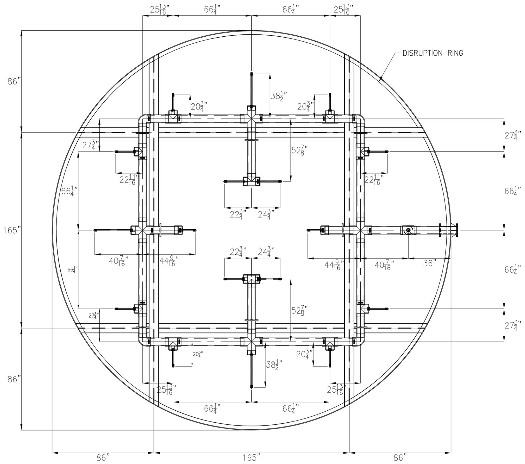
**DETAIL E – EXISTING LIQUID DISTRIBUTION SYSTEM/SPRAY HEADER LINE**
