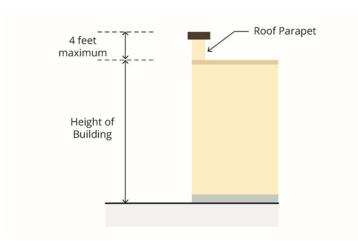
FIGURE 3-4 PARAPET WALL HEIGHT
