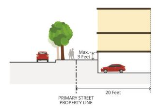
FIGURE 3-11H UNDERGROUND AND TUCK UNDER PARKING, MAXIMUM
